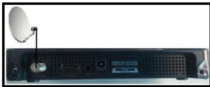
Imagen 29. Conexión a la antena satelital
