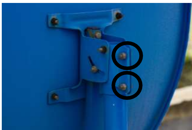
Imagen 24. Fijación de Elevación y Azimut
